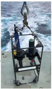
Figure 15-YSI Exo1 Sonde and IMO Ms9 light
